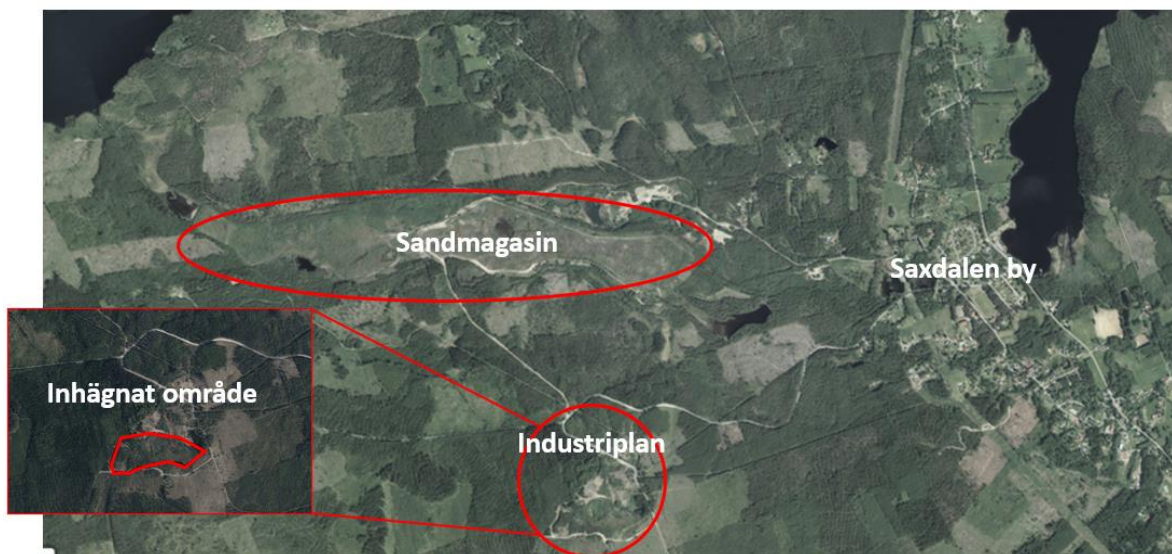
Figur 48: Flygbild över området med sandmagasinen och industriområdet markerade, samt ungefärlig markering av det inhägnade rasriskområdet. Flygbild: Boliden AB
