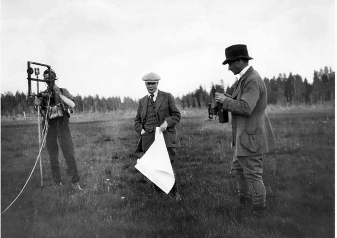
Elektromagnetisk tvåramsmätning i Mensträsk. Direktör Oscar Falkman ses längst till höger och ingenjör Karl Sundberg i mitten.
