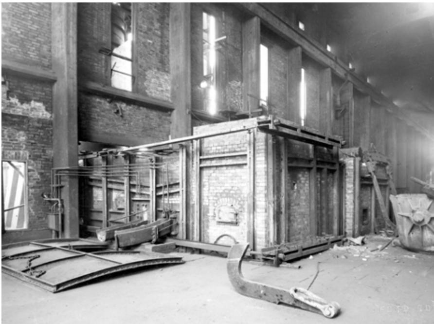
Testugnen där man experimenterade med flashsmältning 1947.
